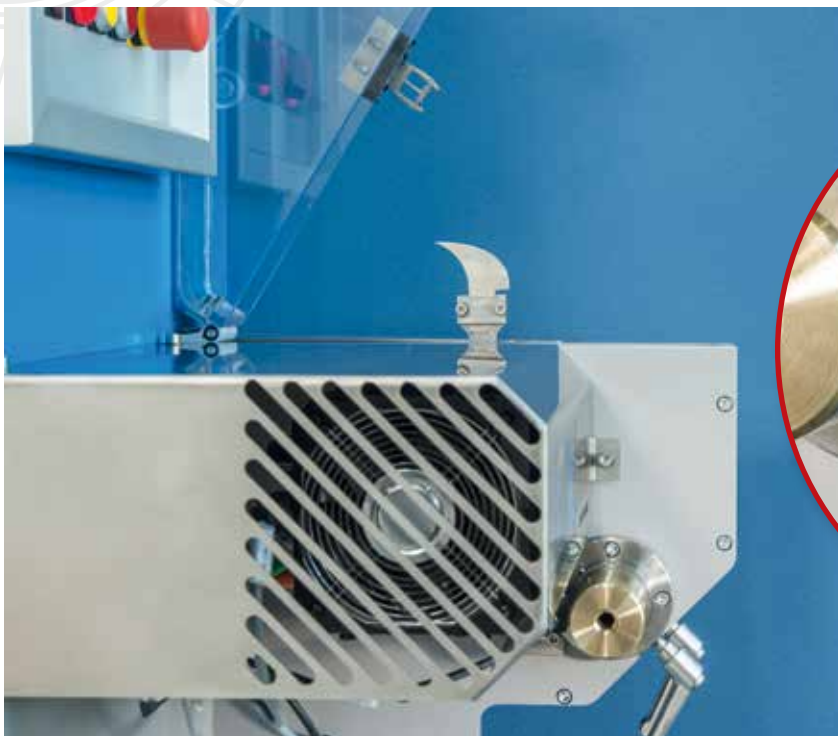
Schneidföhrung mit werkzeuglosem Schnellwechselsystem
